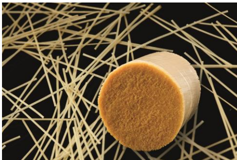
Synthetische vezel „Concrix“; enkel en gebundeld
